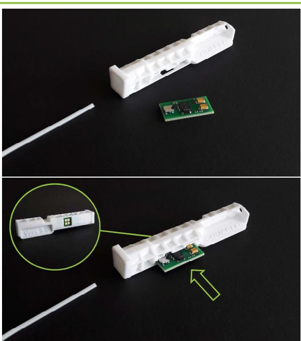
Schritt 3: Mitgelieferten Chip in leeren iSQUARED-Adapter einlegen und mittig positionieren.
