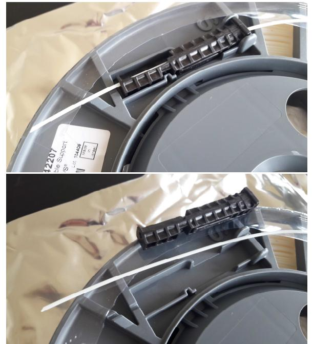
Schritt 2: Spulenadapter aus Halterung nehmen und Filament-Faden herausziehen.
